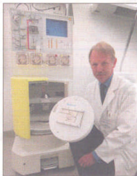
In dieser Zentrifuge werden die Stammzellen separiert.
