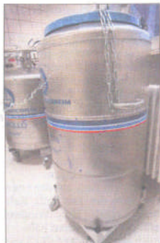
In diesem Kühl-Behälter werden die Stammzellen gelagert.
